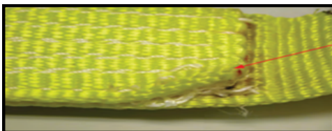
CORTURA ROTA/ DESGASTADA
